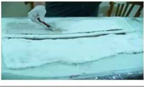
شكل (١٨) يوضح بداية تطبيق محلول الإنزيم على الكمادة القطنية الموضوعة على الأجزاء الكتانية.
